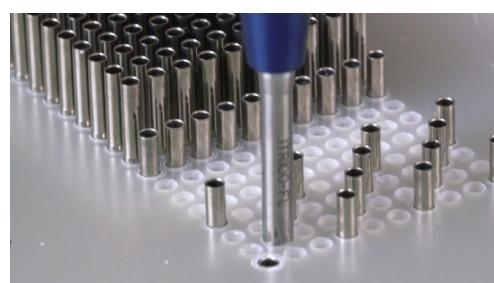
对于安装在丙烯酸或类似塑料的025-16系列针套，您可以通过安装板，用尖嘴钳轻轻拉动预先连接的电线或针套主体，将针套拆除。如果用尖嘴钳拉动针套，通常最好将探针留在针套中，因为探针有助于针套抵抗挤压。如果电线缺失，可以用平推器直接向下推针套背面，迫使针套向上穿过安装板。也可以使用直径为0.021[0.53]的量规销。将其放在针套顶部，然后轻轻地将针套推出。
