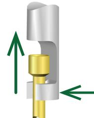
如果针脖拔出或断裂, 探针管和弹簧残留在针套中, 则可以在不损坏针套的情况下将其拆除。始终使用尖嘴钳拆下剩余部件, 如针脖或弹簧, 可开始以下任一选项:
